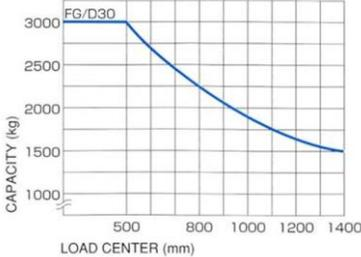
左圖堆高機荷重圖中，如荷載中心位於 80 公分位置時，其限制荷重為①1500 kg②1750 kg③2000 kg④2250 kg。
